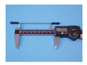
Montage des Nickservogestänges. Der Servoarm wird bei allen Servos noch nicht angeschraubt, bis das Flybarless-System zum ersten Mal bestromt wird und sich ohne aufgesteckten Servoarm die Mittelstellungen einstellen.
