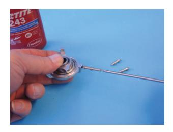
Das Nickgestänge wird aus einem Gestänge 106mm H33 und zwei Kugelgelenken 041 hergestellt. Es hat eine Länge zwischen den Kugelgelenken von 88mm. Kugelgelenke so einstellen, dass zum Aufklipsen die Beschriftung "2.5" immer nach außen steht.
