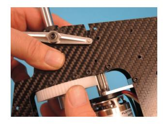
Auf das freie Ende der Motorwelle wird die Messing-Distanzhülse S988 geschoben.
