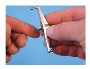
Diese Einheit dann in das Loch der linken Chassisplatte schieben und mit einer Stoppmutter M3 008 sichern. Zum Halten der Mutter eignet sich besonders gut der Maulschlüssel 707.
