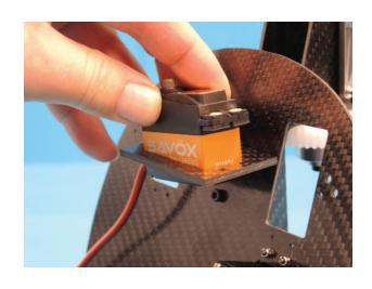
Zur Montage der M2 Stoppmuttern des Heckrotorservos verwendet man zum Andrehen am besten eine kleine Spitzzange und nach den ersten Umdrehungen einen 4mm Maulschlüssel.
