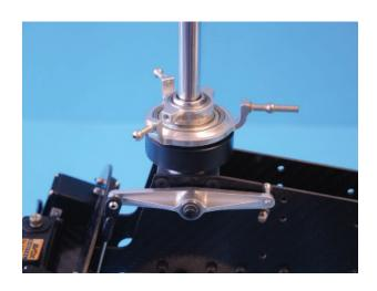
Die Rollservogestänge werden aus zwei Gestängen 92mm H32 und Kugelgelenken 041 hergestellt. Die Gestängelänge zwischen den Kugelgelenken ist 74mm.
