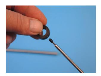
In der Hauptrotorwelle befindet sich ein kleines Positionsloch, dass mit der Spitze der Madenschraube fluchten muss. Ist das Loch gefunden, Madenschraube festziehen.
