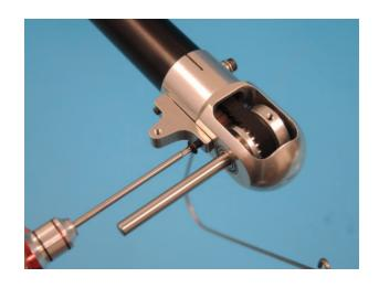
Das hintere Endes des Hecksporns wird mit einer Schraube M3x6 D196 und U-Scheibe M3 002 unter dem Schraubenkopf befestigt.
