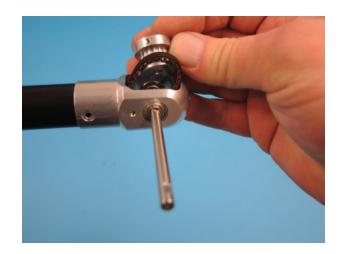
Ansicht des montierten Heckrotorgehäuses.
