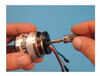
Das Ritzel wird so ausgerichtet, dass es mit der Fläche auf der Motorwelle korrespondiert.
