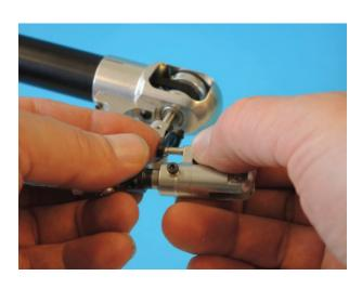
Ist das Kugelgelenk zu schwergängig, wird mit einer Zange vorsichtig(!) aussen auf das Kugelgelenk gedrückt und dieses dadurch leicht geweitet. Ist die Gängigkeit ok, wird das Kugelgelenk abgeklipst und die Prozedur mit der anderen Paarung (anderes Gelenk, anderer Bolzen!) wiederholt. Die Paare sollten zusammen bleiben, hier aufpassen, nicht verwechseln.
