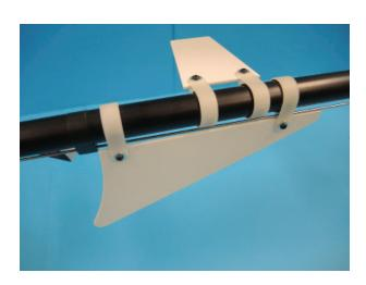
Der Hecksteuerdraht H49 wird mit zwei niedrigen Gestängeführungen H46 und einer hohen Führung H45 versehen. Das hintere Kugelgelenk S996 wird auf den Umlenkhebel aufgeklipst und evtl. gangbar gemacht. Dann werden beide Kugelgelenke aufgeschraubt, in Umlenkhebel bzw. Kugel des Heckservoarms geklipst und die Länge so eingestellt, dass sowohl Umlenkhebel als auch Servoarm rechtwinklig stehen. Lichter Abstand des vorderen hohen Bocks zum Chassis etwa 6-8mm.
