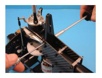
Einzelteile der Heckrotoransteuerung.
