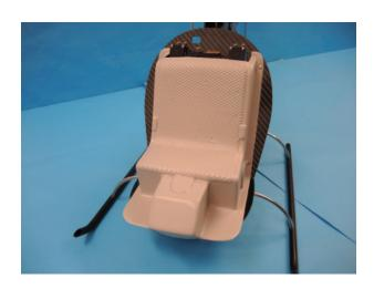
Dann werden die beiden Bohrungen in der Bodenplatte durchgebohrt...
