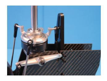
Einzelteile der Rotorkopflagerung. Hinweis: Die Montage des Rotorkopfes ist bis auf die Anlenkstangen und den SRC-Arm identisch mit dem Diabolo 550. Man kann hierzu also auch die grafische Anleitung dieses Modells benutzen.
