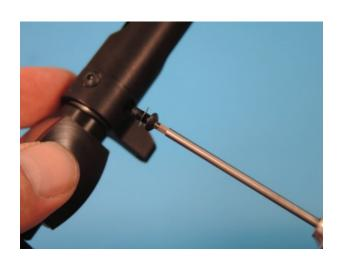
Das R/L-Gestänge H35 wird mit einem Kugelgelenk mit Kugel D72 und einem Kugelgelenk mit Bolzen D324 versehen. Das Kugelgelenk mit der Kugel kommt auf die Seite mit dem Linksgewinde (durch eingedrehten Ring gekennzeichnet. Dadurch wird später bei einer Einstellwinkeleinstellung der Blätter eine Rechtsdrehung weniger und eine Linksdrehung mehr Pitch bewirken.
