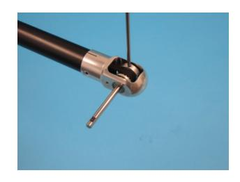
Der Hecksporn S868 wird etwa mittig über einem Besenstiel gebogen, bis ein Öffnungswinkel von etwa 30° entsteht. Beim Biegen auf die korrekte Lage der Ösen achten, so dass man den Sporn später auch anschrauben kann. Dieser wird zuerst vorne mit einer Schraube M3x35 D338 mit U-Scheibe M3 002 unter dem Schraubenkopf und Passscheibe 3x6x0,5 D312 nach Aufschieben des Drahtes versehen.
