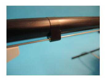
Lichter Abstand des hinteren Bocks zum Heckrotorgehäuse ca. 80mm.
