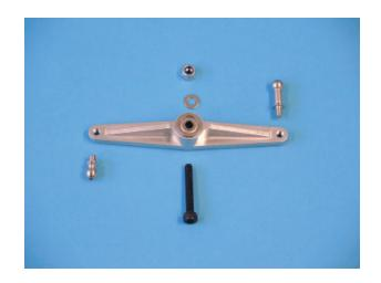
Der Kugelbolzen M3x9 078 wird auf der flachen Seite des Umlenkhebels S956 eingeschraubt. Der Kugelbolzen M3x4 076 auf der gegenüberliegenden Seite wird auf der Seite mit den beiden Verstärkungsrippen eingeschraubt.
