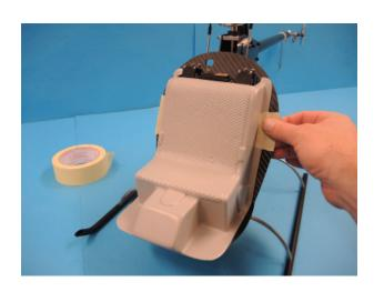
Nun wird mit einem 2mm Bohrer zuerst die linke untere Verschraubung durchgebohrt. Dazu lässt man den Akkuschrauber ganz langsam drehen und beobachtet, ob der Bohrer an der richtigen Stelle den Sitz durchbohren wird (weißer Punkt im Kunststoff), ggf. nachrichten.
