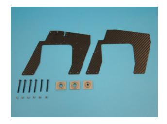
Zwei Senkschrauben M3x35 D324 werden in die beiden oberen Löcher der linken Chassisplatte eingesetzt und der Lagerbock H03 mit Lagerflansch nach oben aufgeschoben. Ebenso werden darunter zwei Schrauben M3x35 D338 und der untere Lagerbock H03 mit Flansch nach unten aufgeschoben. Dann wird die rechte Chassisplatte H02 aufgesetzt und mit 4 Stoppmuttern 008 noch lose gesichert.
