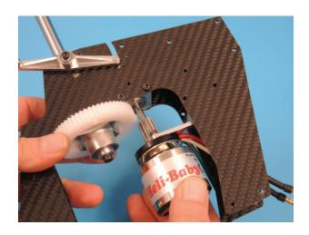
Die Löcher im Chassis sollten mit den Löchern des Motorträgerhalters ohne Kraft fluchten, ggf. Höhe des Motorritzels nachjustieren.
