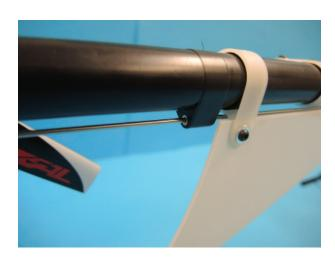
Auf das Heckgestänge werden an beiden Enden ein Kugelgelenk 2mm S996 aufgeschraubt. Das Gewinde muss vollständig in das Kugelgelenk eingedreht werden, um einen möglichen Vibrationsbruch zu vermeiden. Der Umlenkhebel wird zum Aufklipsen des Kugelgelenks abgeschraubt. Hierbei wieder auf Leichtgängigkeit des Kugelgelenks achten, ggf. wie zuvor beschrieben mit einer Zange vorsichtig gängig machen.
