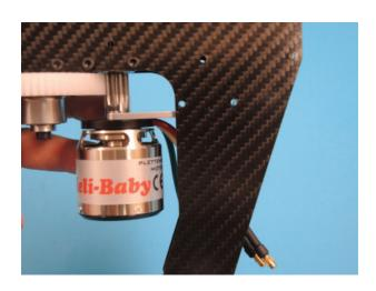
Die Motoreinheit wird mit zwei Schrauben M3x35 D338 und Stoppmuttern 008 verschraubt.
