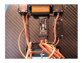
Zur sauberen Kabelführung wird ein Kabelbinderpad D342 auf der linken Chassisseite plaziert.
