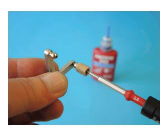
Das Heckriemenrad wird mit zwei Madenschrauben M3x5 0737 gesichert, wobei zuerst die Madenschraube auf die Fläche der Heckrotorwelle angezogen wird (durch Wackeltest richtige Position überprüfen) und dann erst die zweite Madenschraube auf dem Wellenumfang. Die Heckrotorwelle sollte rechts bündig mit dem Lager abschließen.
