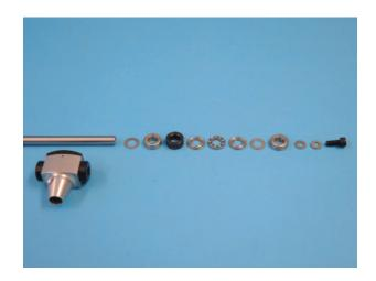
Die Blattlagerwelle D536 wird in die im Lieferzustand fertig gebaute Rotornabe D553 eingeschoben und mittig plaziert.
