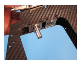
Die Hauptzahnradeinheit wird aufgeschoben und man kontrolliert, ob die Hauptrotorwelle ganz leicht aus den Lagern hervorsteht. Ist dieser Freistand zu gross, kann er mit Passscheiben 10x16x0,1 oder 0,2 046 bzw. 033 verringert werden. Ist er zu klein, kann er mit Passscheiben 5x10x0,1 044 vergrößert werden.
