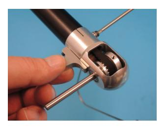
Das hintere Ende des Halters wird mit einer Linsenschraube M3x6 D199 an das Gehäuse geschraubt (Loctite).
