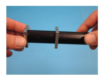
Der Zahnriemen H40 wird durch das Heckrohr geschoben oder, wenn es nicht rutscht, mit einem gekröpften Draht durchgezogen.
