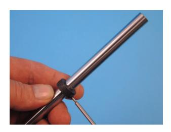
Zwei weitere silberne Madenschrauben M3x4 081 werden mit Loctite versehen und in den Stellring eingeschraubt.
