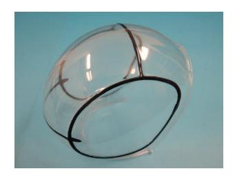
Die Kabinenhaube wird nach dem Aufsetzen mit zwei O-Ringen D66 an den Zapfen gesichert.
