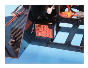
Ansicht des Durchbruchs in der Rückwand für die Verkabelung des Microbeasts.
