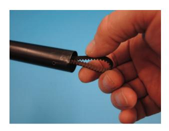
In das Heckrotorgehäuse D555 wird die Heckrotorwelle D556 etwas eingeschoben und die Distanzscheibe D558 mit dem Bund zum Kugellager innen auf die herausstehende Welle aufgelegt.
