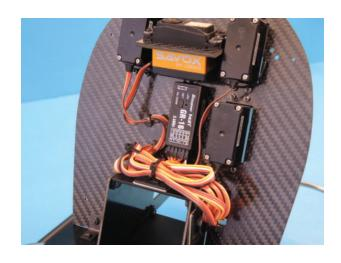
Beide Antennen werden in gleicher Länge möglichst weit über die Rückwand herausstehend mit zwei Kabelbindern kurz befestigt. Beim Heli-Bayb ist diese Anordnung sehr wichtig, da die CfK Rückwand eine große Fläche des Modells abschirmt.
