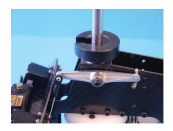
Die Taumelscheibe wird auf die Hilfe aufgelegt. Diese Höhe stellt die spätere Null-Grad-Grundstellung dar, an dem sich Servogestänge und Rotorgestängelängen orientieren.
