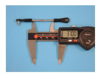
In den SRC-Arm H36 wird mit hochfesten Loctite 270 das Gestänge 52mm H37 völlständig eingeschraubt, sodass kein freistehendes Gewinde vorhanden bleibt (Bruchgefahr). Auf das andere Ende wird ein Kugelgelenk mit Bolzen D324 aufgeschraubt. Dieses Gestänge hat an beiden Enden ein Normalgewinde (rechtsherum drehend).
