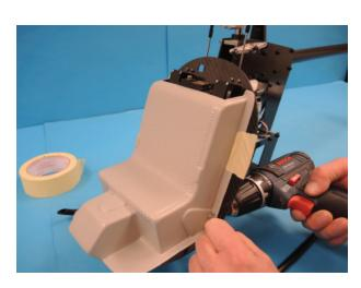
Eine M2x5 Schlitzschraube D343 wird durch das Loch gesteckt und mit einer Mutter M2 S010 von Hand ohne Loctite verschraubt. Die Sitzschrauben bitte niemals mit Loctite sichern, ein eventuelles Lösen im Betrieb wäre unkritisch und die Schrauben müssen sich zur Wartung immer wieder leicht lösen lassen.
