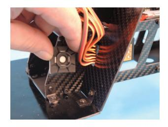
Die Kabel weden dann spannungsfrei und nicht zu stramm gebündelt mit einem Kabelbinder kurz D316 auf dem Pad gesichert.
