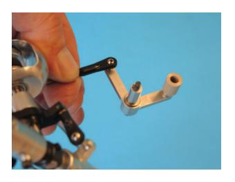
DerUmlenkhebel wird nun mit Loctit an den Halter geschraubt. Darauf achten, dass sich die Kugel hierbei im Kugelköcher befindet.
