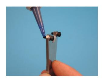
Diese Einheit wird so mit den beiden Schrauben des Motors verschraubt, dasss die Motorkabel zum Motorträger zeigen.
