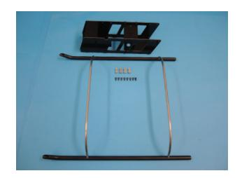
Je vier Senkschrauben M3x8 025 werden in das vordere und hintere U-Profil eingesetzt und am Gewinde mit Loctite versehen.
