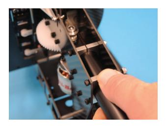
Die unteren beiden Schrauben werden festgezogen und der Riemen durch Herausziehen des Rohres gespannt.
