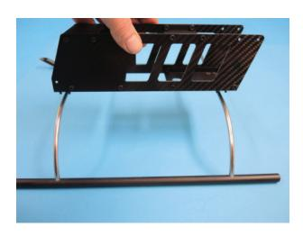
Das Landegestell wird mittels vier Kufenhaltern H21 mit dem Chassis noch lose verschraubt.
