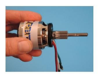
Dann wird etwas Loctite auf das Gewinde der Madenschraube M4x4 573 gegeben und in das Ritzel geschraubt, die auf die Fläche drückt. Ob sie das macht, kann man überprüfen, indem man die Madenschraube leicht löst und ein Hin-und Herwackeln des Ritzel mit beidseitigem Anschlag spüren kann, ohne dass dieses von der Welle abziehbar ist. Sollte das der Fall sein, kann man das Ritzel festziehen (1,7Nm).
