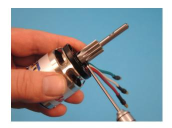
Zwei Passscheiben 3x6x1 051 werden auf Schrauben M3x8 aufgeschoben und diese dann auf den Motorträger H10 gesteckt und an den Gewinden mit Loctite versehen.
