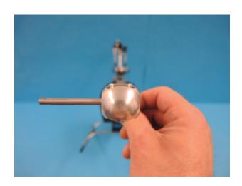
Passen Heckriemenspannung (nicht zu locker, nicht zu fest :-) ), so können auch die oberen beiden Schrauben angezogen werden. Die Schlitze in den Schellen sollten dabei aber nicht verschwinden. Es genügt, wenn das Heckrohr fest sitzt.
