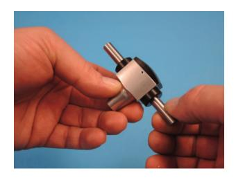
Dann werden wie oben gezeigt die einzelnen Elemente aufgeschoben, wobei als Grundwert die innere Passscheibe 0,5mm dick ist und die äußere 0,2mm. Erst zieht man die äußeren M5 Schrauben handfest an und prüft die Leichtgängigkeit der Lager. Ist Spiel auf der BLW vorhanden, ist eine Scheibe außen zu ergänzen. Ansonsten muss man außen eine dünnere Scheibe einsetzen. Ist alles gut, dann die Blattlagerschrauben mit Loctite versehen und festziehen.
