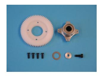
Der Freilauf H08 wird in die mit der Ausdrehung versehene Seite des Hauptzahnrades H07 gedrückt, wobei man auf eine Fluchtung von Löchern und Gewindebohrungen achten muss.
