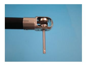
Die Taumelscheibenführung wird entfernt und der Riemen eingehängt. Die Heckrohrhalter werden mit dem Schlitz nach oben positioniert.
