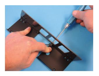
Die linke untere Chassisplatte H13 auf gleiche Weise mit vier Schrauben M3x6 D196 und Muttern M3 D547 anschrauben.
