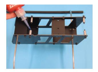
Dann werden die Schrauben soweit zurück gezogen, bis die Gewinde vollständig in den Verbindern verschwunden sind.
