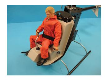
Die Stege der Kabinenhaube S872 werden mit dem beiliegenden Edding 3000 Flizstift schwarz ausgemalt. Zuerst werden die Außenkanten der Stege gezogen. Dabei empfiehlt es sich, den Filzstift immer ein bisschen zu drehen, so dass auf die Dauer kein eingetrockneter Bereich an der Spitze entsteht.
