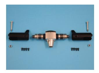
Die Blattgriffe werden ggf. nach Erwärmung im Ofen auf 150°C (Topflappen verwenden) aufgeschoben und die Löcher fluchtend zu denen des Halteringes D537 ausgerichtet. Dann weden die Blattgriffe mit je 4 Schrauben M3x6 D199 und unterliegenden Passscheiben 3x6x0,2 455 lose verschraubt (Loctite!). Vor dem Festziehen beide Blattgriffe kräftig nach außen ziehen. Dazu werden die Blatthalteschrauben eingesteckt und dann wird mittels zweier 12mm Rundstäbe an den Griffen gezogen.
