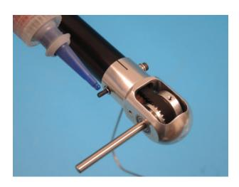
Der Umlenkhebelhalter D560 wird an seinem vorderen Ende aufgeschraubt.
