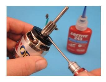
Eine zweite Madenschraube M4x4 573 wird mit Loctite versehen (auf das Gewinde, nicht auf die Fläche!) und festgezogen (1,7Nm).
