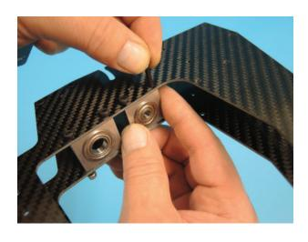
Damit die drei Lagerböcke perfekt zueinander fluchten, drückt man diese nun während des Anziehens der Schrauben leicht nach unten bzw. nach oben. Sind alle Schrauben angezogen, kontrolliert man nochmals die Parallelität beider Seitenplatten an den unteren Enden.
