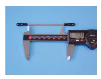
Das hintere Nickgestänge wird aus einer Madenschraube M2.5x12 520 und zwei Kugelgelenken 041 hergestellt. Die Kugelgelenke werden soweit aufgeschraubt, dass der Nickumlenkhebel bei der gezeigten TS-Grundstellung horizonal steht. Dabei steht noch ca 1mm Gestänge frei heraus.
