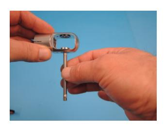
Das Heckrotorgehäuse wird auf das Rohr aufgesteckt und der Riemen wie im Bild gezeigt durchgeführt. Dann wird das Riemenrad D579 in den Riemen eingehängt, in das Gehäuse geschoben und die Welle danach ganz eingeschoben.
