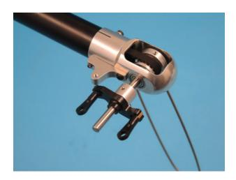
Der vorbereitete Umlenkhebel wird mit einer Schraube M3x25 D336 und der Distanzhülse H42 noch ohne an den Umlenkhebelhalter geschraubt, wobei der Kugelköcher am Umlenkhebel in die Kugel des Schiebers greifen muss. Bauen Sie nun den Heckrotor wie auf der nachfolgendenSeite gezeigt auf.
