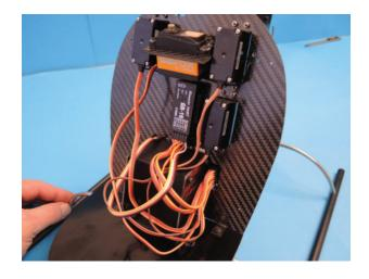
Platzierung des Empfängers, hier ein Graupner GR16. Der Empfänger sollte so plaziert werden, dass beide Antennen möglichst mittig unter dem Heckservo sitzen, um bei der Befestigung dieser dann gleiche Längen zu haben.
