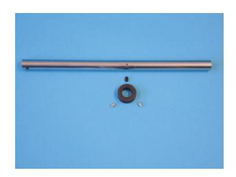
Eine schwarze Madenschraube mit Spitze M3x5 D314 wird mit Loctite in den Stellring H06 eingesetzt.
