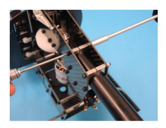
Abschließend wird die Taumelscheibenführung wieder montiert und die Schrauben nun festgezogen.
