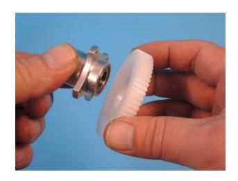
Vier Senkschrauben M3x8 025 werden mit Loctite erst lose eingeschraubt und dann über Kreuz festgezogen (3,9,12,6 Uhr).
