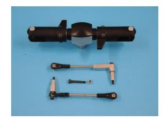
Der Rotorkopf wird mit der Rotorkopfschraube D538 und einer Stoppmutter M3 an der Rotorwelle befestigt. Zum Aufsetzen kann man die Welle und die Nabe innern mit etwas Öl schmieren und die Welle dann "einkippeln". Welle niemals in der Nabe drehen, allenfalls zum genauen Einstellen der Fluchtung der Querbohrungen.
