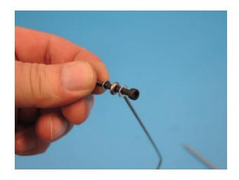
Diese Einheit wird dann durch Heckrotorgehäuse und Heckrohr geschoben.
