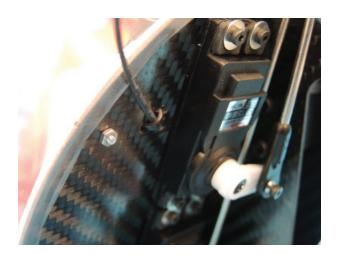
Der Kabelclip D348 wird zur Führung des Akkuanschlusskabels wie gezeigt mit einer Schraube M3x8 und einer Unterlegscheibe 004 befestigt.
