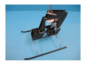
Einzelteile der Rückwandverbindung und Heckservomontage
