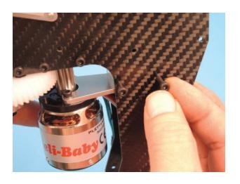
Das Getriebespiel wird überprüft, indem man das Hauptzahnrad leicht hin- und herbewegt. Dabei sollte ein leichtes, aber sicher spürbares Getriebespiel vorhanden sein. Ist das Getriebespiel zu gering, dann Schrauben der Rotorwellenlagerung nochmals leicht lösen, Welle in Flugrichtung nach vorne ziehen und wieder festziehen. Ggf. kann man gleiches mit dem Motorstrang in Flugrichtung nach hinten durchführen.
