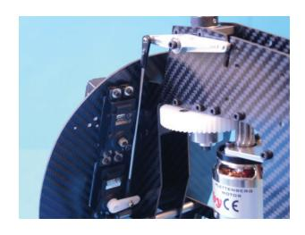
Die Taumelscheibeneinstellhilfe D529 wird mit der Aussparung nach oben aufgeschoben.
