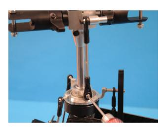
Das SRC-Gestänge wird oben mit einer Schraube M3x30 D337 und dem glatten Blattarm D542 montiert (Loctite). Der Kugelbolzen unten wird wieder mit Loctite am Außen- und Innengewinde in die Taumelscheibe eingeschraubt. Die Länge beider Gestänge sollte jetzt einmal vorläufig kontrolliert werden, ob sich bei der Nullstellung der Taumelschaube auch etwa 0° am Blattgriff ergeben. Die Feineinstellung folgt später bei Inbetriebnahme des FBL-Systems.
