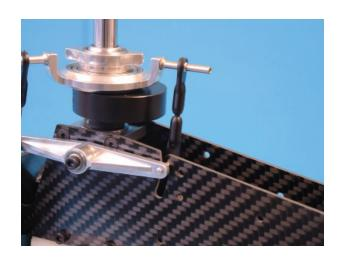
Die Taumelscheibenführung H34 wird provisorisch mit zwei Schrauben M3x35 D338 und Stoppmuttern M3 angebracht. Bei der Heckrohrmontage wird sie dann wieder kurz entfernt, um den Zahnriemen leichter einhängen zu können.
