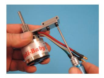
Die Motoreinheit wird von unten in das Oberchassis geschoben.
