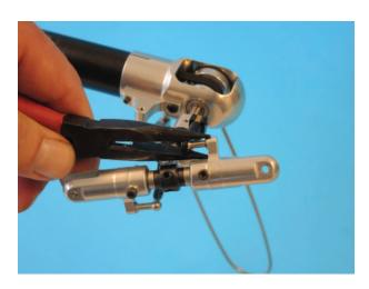
Dann die Kugelgelenke aufklipsen, dabei auf die richtige Paarung achten und den Heckrotor auf die Heckrotorwelle aufschieben.
