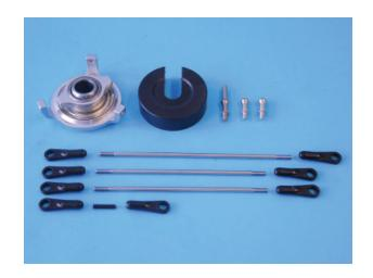
In den Taumelscheibenkörper D528 werden mit Loctite zwei Kugeln 078 und ein Kugelbolzen mit Führung D530 eingeschraubt.
