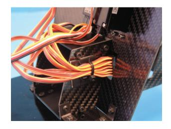
Ein zweites Kabelpad D342 wird [beim Microbeast] auf der Gyroplattform befestigt.
