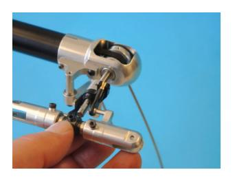
Der Heckrotor wird bündig aufgeschoben und mit einer Madenschraube M4x5 035 auf der Fläche der Heckrotorwelle gesichert (Loctite).
