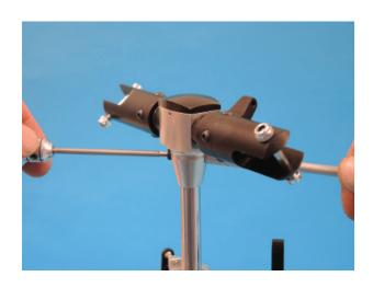
Das Doppelkugelgelenk wird oben mit einer Schraube M3x30 D337 und dem gestuften Blattarm D540 montiert (Loctite). Der Kugelbolzen unten wird mit Loctite am Außen- und Innengewinde in die Taumelscheibe eingeschraubt.
