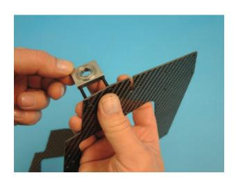
Der Lagerbock der Motorwelle H04 wird zwischen die Chassisplatten geschoben und mit zwei Schrauben M3x35 D338 sowie Stoppmuttern 008 lose angeschraubt. Unter lose versteht man, dass die Verbindung bis zum ersten Kontakt angezogen und dann wieder leicht gelöst wird, so dass sich alle Teile wieder untereinander bewegen können.
