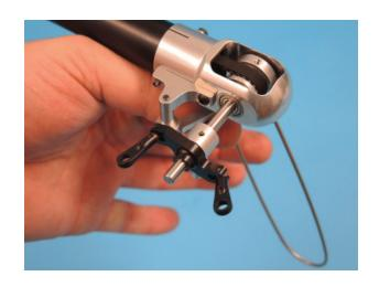
Nun wird das erste Kugelgelenk auf den ersten Kugelbolzen am Heckrotor aufgedrückt und die Gängigkeit überprüft. Die minicopter-Kugelbolzen sind von der Toleranzlage stets Richtung stramm orientiert, da man an "zu locker" nichts ändern kann, wohl aber umgekehrt. Dieser Arbeitsgang muss unbedingt nacheinander erfolgen, da man die Leichtgängigkeit bei zwei gleichzeitig aufgeklipsten Kugelgelenken nur schwer prüfen kann.
