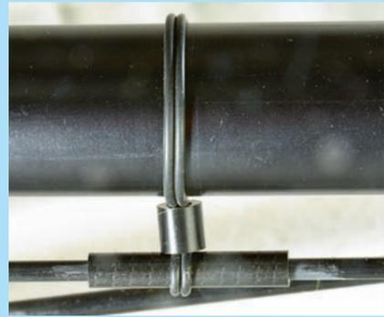
Die Ansteuerung des Heckrotors erfolgt wie bei den *Jokern* mit einem 4-mm-CfK-Rohr, das zur Schwingungsunterdrückung allerdings nun in zwei elastisch gelagerten Kunststoffhüsen geführt wird.
