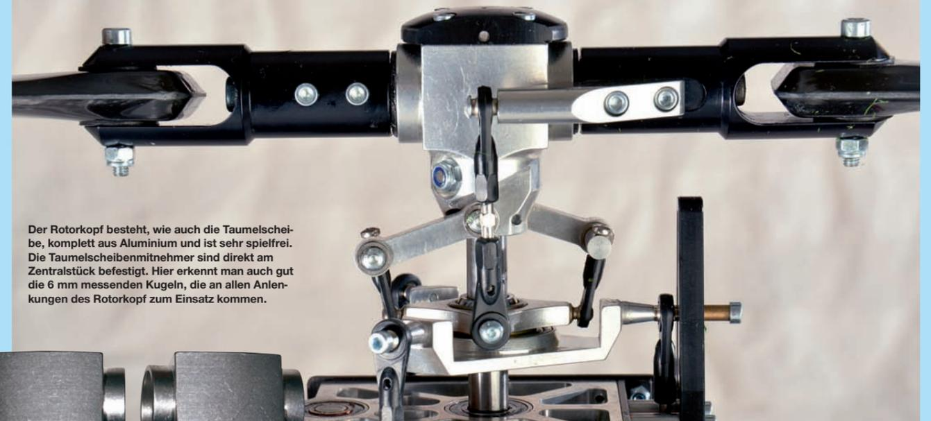
Der Rotorkopf besteht, wie auch die Taumelscheibe, komplett aus Aluminium und ist sehr spielfrei. Die Taumelscheibenmitnehmer sind direkt am Zentralstück befestigt. Hier erkennt man auch gut die 6 mm messenden Kugeln, die an allen Anlenkungen des Rotorkopfs zum Einsatz kommen.
