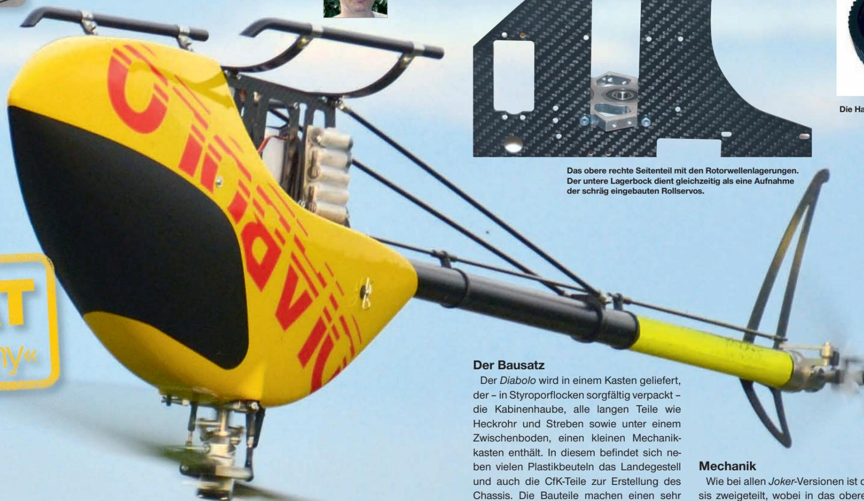
Das obere rechte Seitenteil mit den Rotorwellenlagerungen. Der untere Lagerbock dient gleichzeitig als eine Aufnahme der schräg eingebauten Rollservos.
