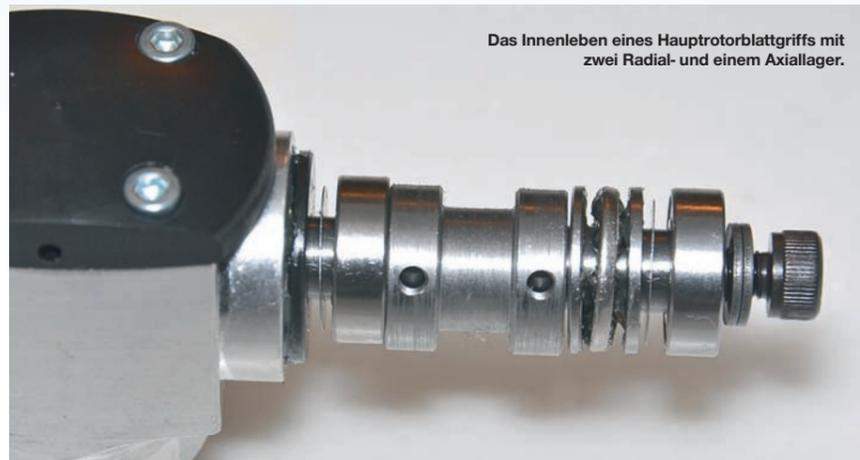
Das Innenleben eines Hauptrotorblattgriffs mit zwei Radial- und einem Axiallager.
