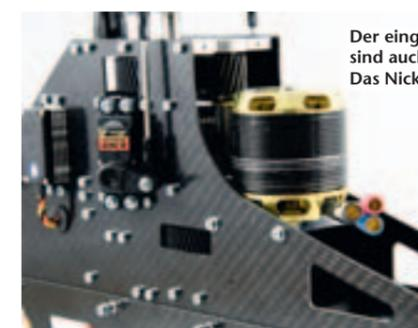
Der eingesetzte Scorpion-Motor. Gut zu erkennen sind auch die leicht schräg stehenden Rollservos. Das Nickservo sitzt hinten im Chassis
