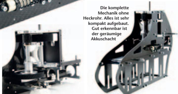
Die komplette Mechanik ohne Heckrohr. Alles ist sehr kompakt aufgebaut. Gut erkennbar ist der geräumige Akkusacht
