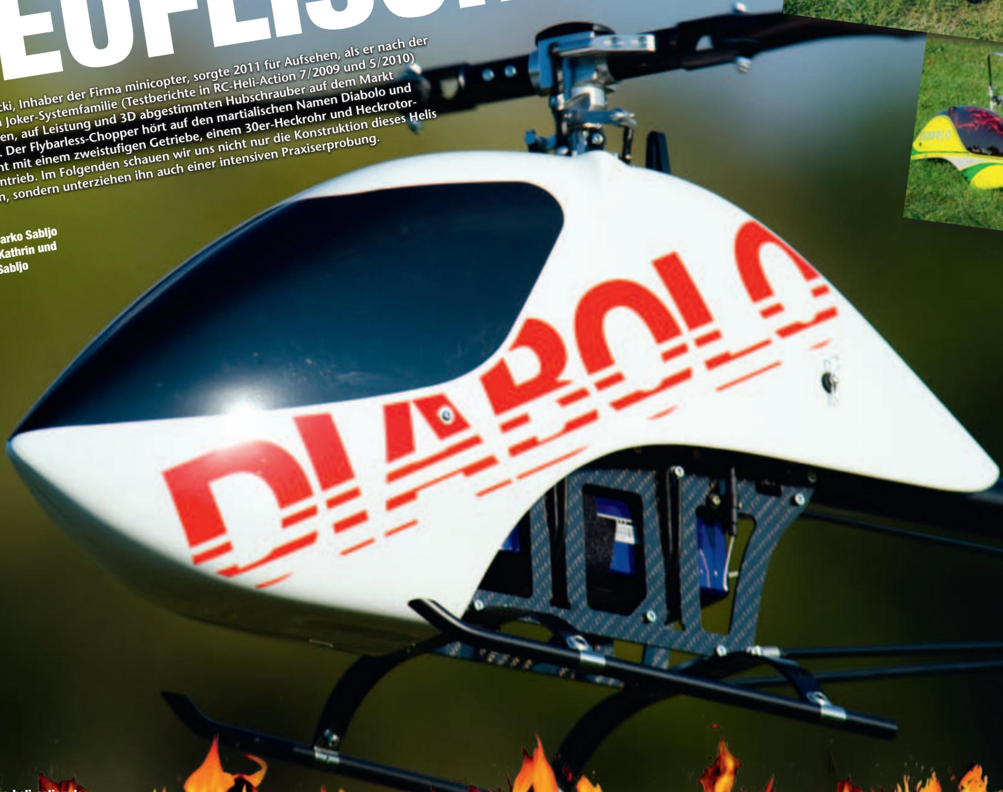
Er handelt sich um einen reinrassigen 700er-3D-Heli, der aber auch im niedrigen Drehzahlbereich betrieben werden kann. Durch das lange Heckrohr mit einem Durchmesser von 30 Millimeter (mm) können problemlos 750er-Rotorblätter geflogen werden.
